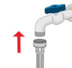
17) Serrez les raccords à la main, puis utilisez une pince pour faire un tour supplémentaire de 1/4" dans le sens des aiguilles d'une montre. **Ne pas trop serrer les raccords, car cela pourrait les endommager.**
